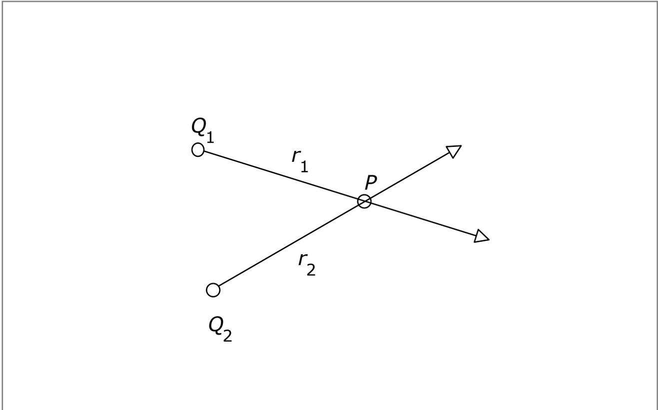
Von zwei Punkten  $Q_1$  und  $Q_2$  gehen zwei Wellen aus, die sich nach Durchlaufen der Strecken  $r_1$  und  $r_2$  im Punkt  $P$  treffen. Will man die Intensität im Interferenzpunkt  $P$  (auf einem Schirm oder Detektor) wissen, so muss man das Betragsquadrat der resultierenden Amplitude berechnen:
