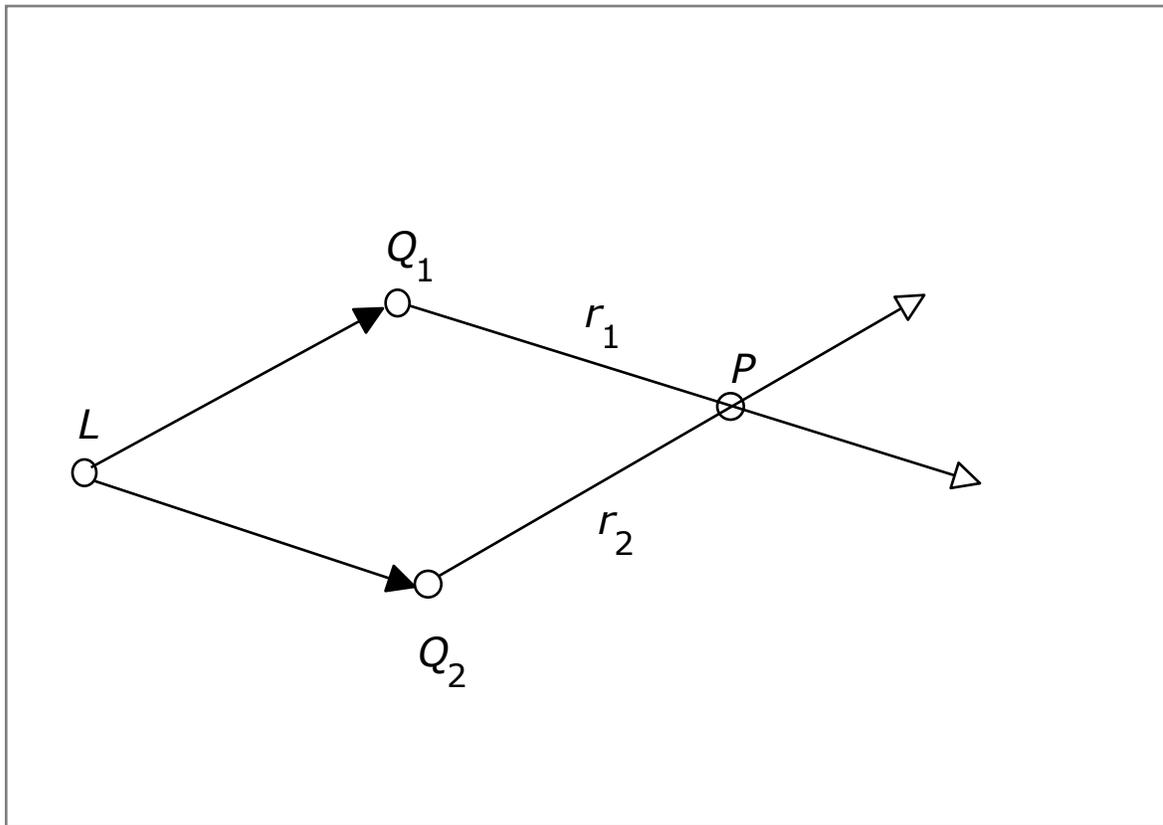
müssen die Phasen  $\phi_i$  aus den Abständen von  $L$  zu  $Q_i$  berechnet werden.
