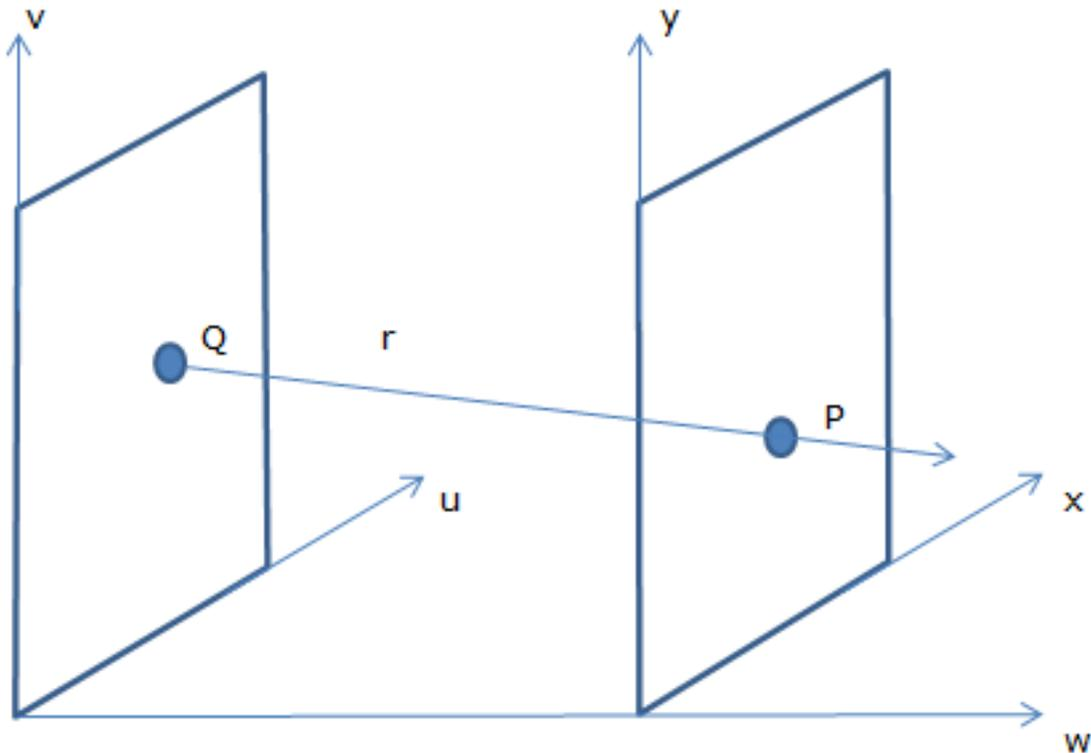
Die Quellen  $Q$  liegen in der  $u$ - $v$ -Ebene. Der Interferenzpunkt  $P$  liegt in der zur  $u$ - $v$ -Ebene parallelen  $x$ - $y$ -Ebene, die zur Ebene der Quellen den Abstand  $w$  hat. Die Phase der Streuwelle ist hier nicht berücksichtigt (ebene Wellen treffen senkrecht auf die  $u$ - $v$ -Ebene).
