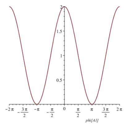
Also das bekannte Interferenzmuster für gleiche Amplituden (= 1 im Bild).
